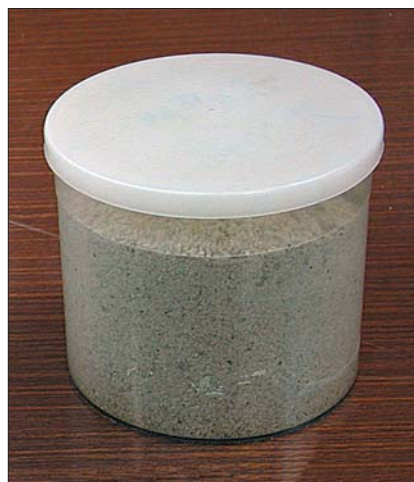
Foto 7.06 Becker di Marinelli utilizzato per l'analisi di radioattività nelle matrici ambientali
