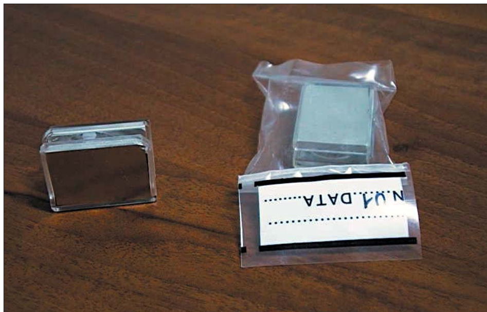
Foto 7.7 Rivelatori a traccia utilizzati per la campagna Radon nelle abitazioni della Regione Puglia
